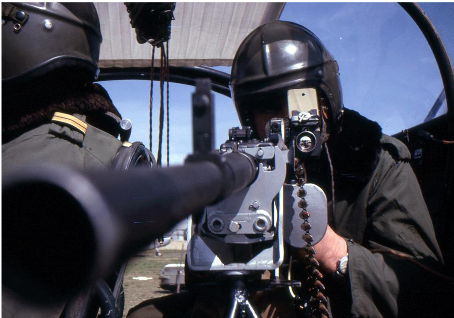
Alouette II n° 1297/BNM armée avec une mitrailleuse AA52.(photo François de Pitray).
