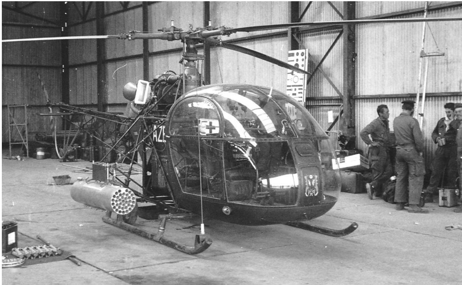
GH N°2 à Sétif, une Alouette armée avec un lance-roquettes Matra LR 361 (photo Emmanuel Egermann).
