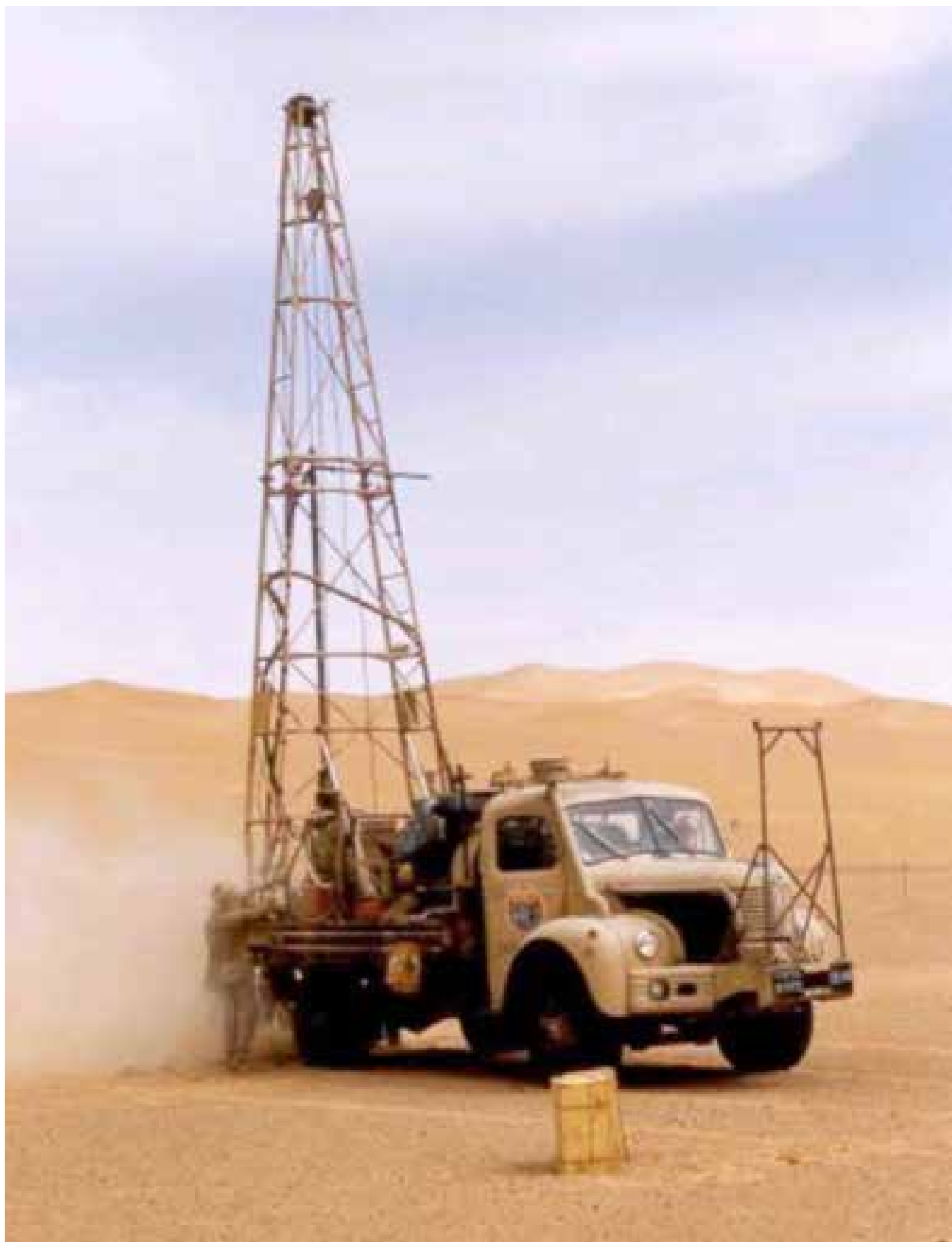
Sonde légère portée par camion pour forer les trous d'explosifs
