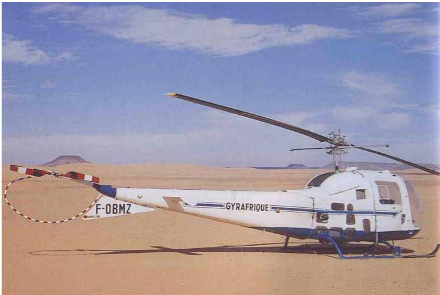
▲ Bell 47 J à Tihigaline. Le Bell 47 J est un dérivé du Bell 47 G, équipé d'un moteur Lycoming VO-540-B1B3 de 260 ch
