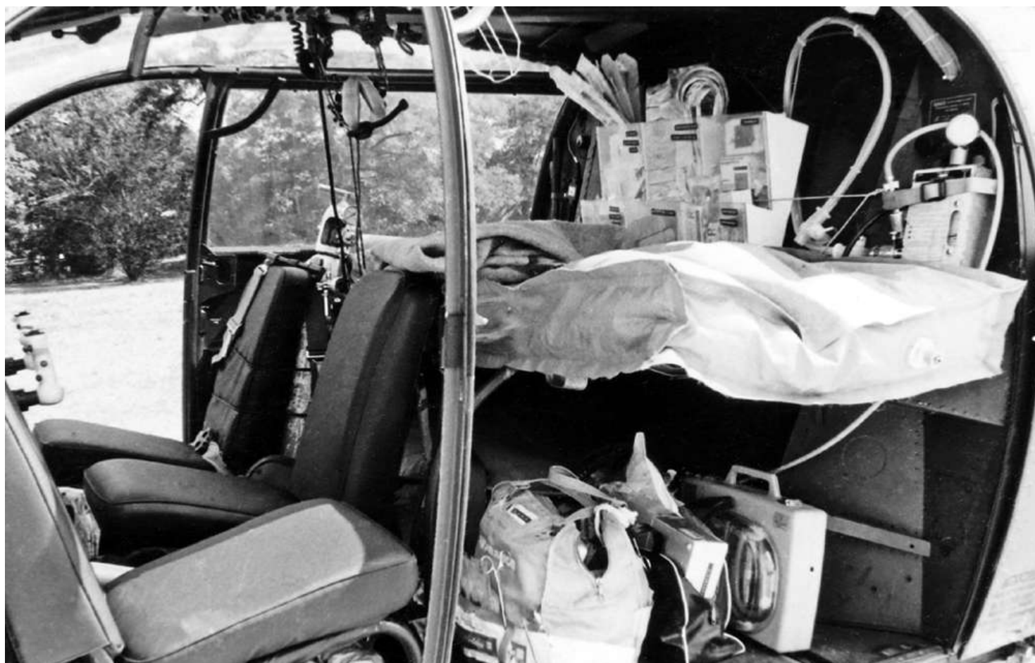
Détail de l'installation intérieure d'une Alouette III du 5 e RHC, équipée pour le "SAMU" (photo Musée de l'ALAT).
