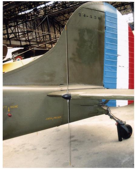
*SB-327 ARC44 en place arrière et, à droite, antenne homing (photos Fred Descamps).*
