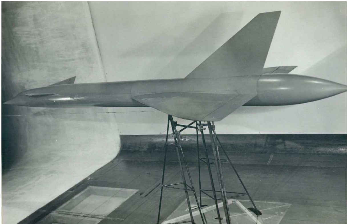
Figure 12 : dernière maquette testée en 1961 pour étudier une configuration de l'Avion de Transport Supersonique, l'A.T.S. 60, préfigurant le Concorde
