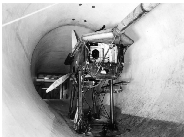
Figure 5 : le moteur Hispano d'origine avec comme ventilateur une hélice de Dewoitine 520 (écoulement de 60 m/s)
