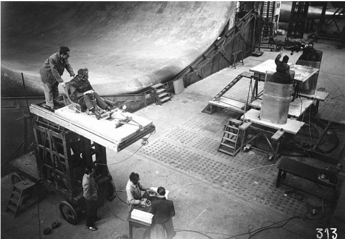
Figure 9 : essais par R. Hirsch, en vol libre télécommandé, de la maquette EA/L1 dite d'Alger dans la soufflerie S1ch de Chalais-Meudon à l'Onera en 1948
