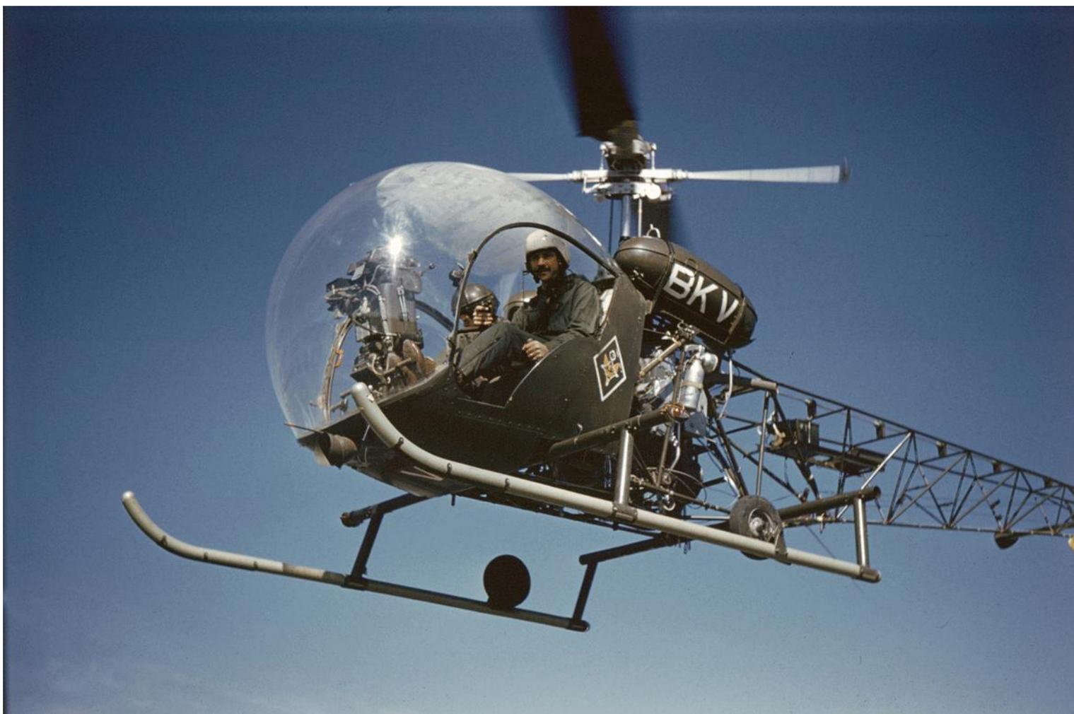
*Ce Bell 47G-2, du PA de la 9<sup>e</sup> DI, revient d'un vol de contrôle après sa révision des 300 heures, à la 676<sup>e</sup> CRALAT, à Chéragas. Il ne reste que les patins à peindre. André Barré, mécanicien de la CRALAT, est aux commandes (photo André Barré).*
