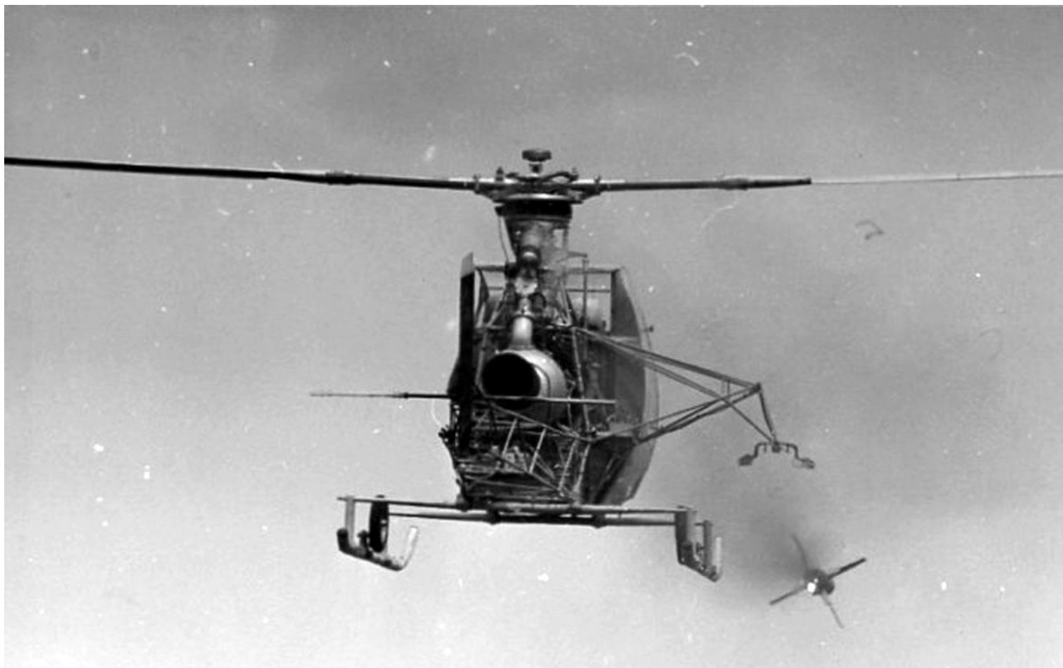
SO 1221, essais de tir de SS-10 filoguidés, c'est le premier hélicoptère français à expérimenter ce type d'armement (photo Roland de Narbonne).
