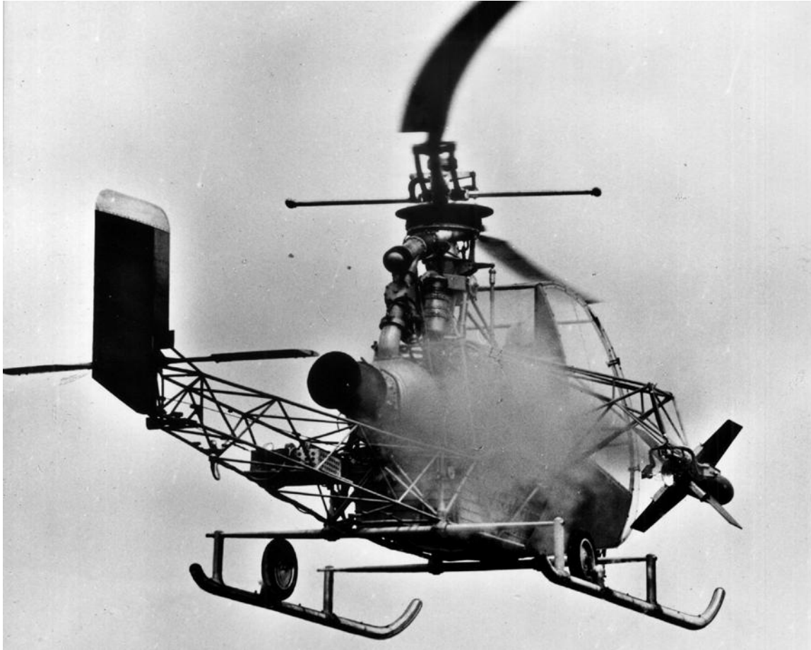
Des essais de tir de missiles SS-10 ont été réalisés à partir de Djinn (photo Sud-Aviation) Ainsi que l'équipement d'une mitrailleuse (photo Joseph Koberlé).
